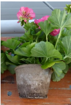
Abb. 6 - 7: Vereinzelt Schimmelbildung am Topf bzw. Topfrand der kompostierbaren Töpfe Jiffy Topf R2 (Jiffy), und Fertipot NT 12 (fertil) (von links nach rechts).
