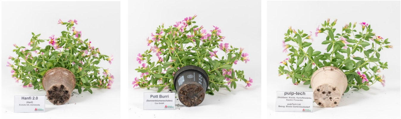
Abb. 2 - 4: Zu Kulturrende zeigten sich die kompostierbaren Töpfe Hanfi Neu, Pottburri und Bioform (von links nach rechts) in allen drei Kulturen (hier Calibrachoa ) in einem sehr guten Zustand
