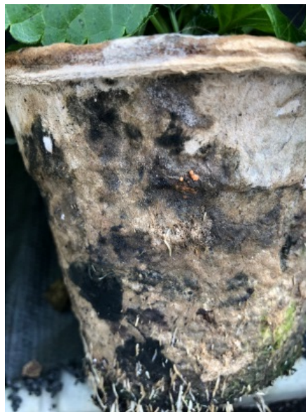
Abb. 9 - 10: Die Töpfe D-Grade evo (Desh) und EcoExpert (Modiform) (von links nach rechts) blieben im Kulturverlauf nicht stabil und wiesen erhebliche Schimmelbildung auf
