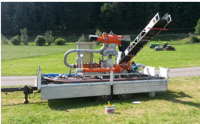
Foto 9: Gülleseparierer für den mobilen Einsatz
