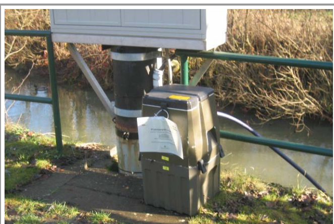
Bild 5: Messeinrichtung zur Erfassung von Pflanzenschutzmitteln in Oberflächengewässern
