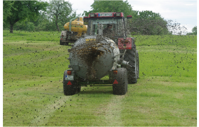
Foto 5: Pendelverteiler (ab 2025 nicht mehr zulässig)
