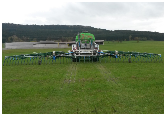
Foto 11: Ausbringung von Biogasgärrest mit Schleppschuhverteiler
