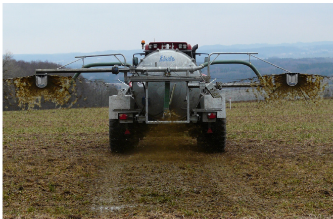
Foto 4: Duplexverteiler (ab 2025 nicht mehr zulässig)
