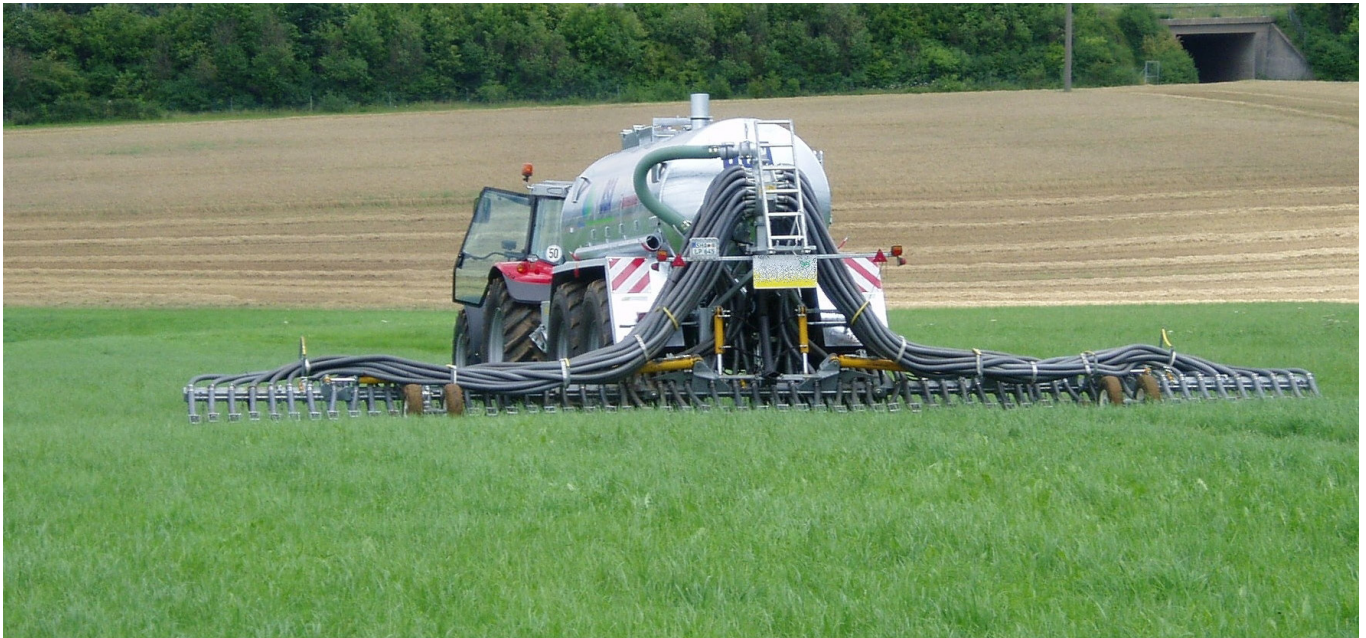
Foto 1: Schleppschuhverteiler ermöglichen bodennahe Gülleausbringung.
