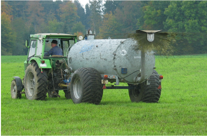
Foto 3: Prallkopfverteiler (ab 2025 nicht mehr zulässig)
